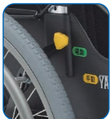
レバーによる手動と 電動の切り替え
